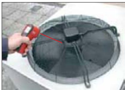
Безопасная диагностика состояния системы путем измерения температуры предохранительных клапанов, насосов и иных изнашиваемых деталей.
