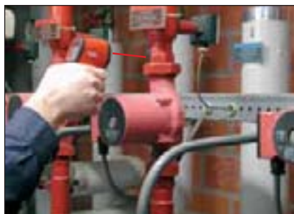
Проверка питающего и возвратного потока всего за несколько секунд для определения КПД систем обогрева / охлаждения.
