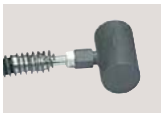
Цилиндрическая замораживающая головка для быстрой смены переходников.
